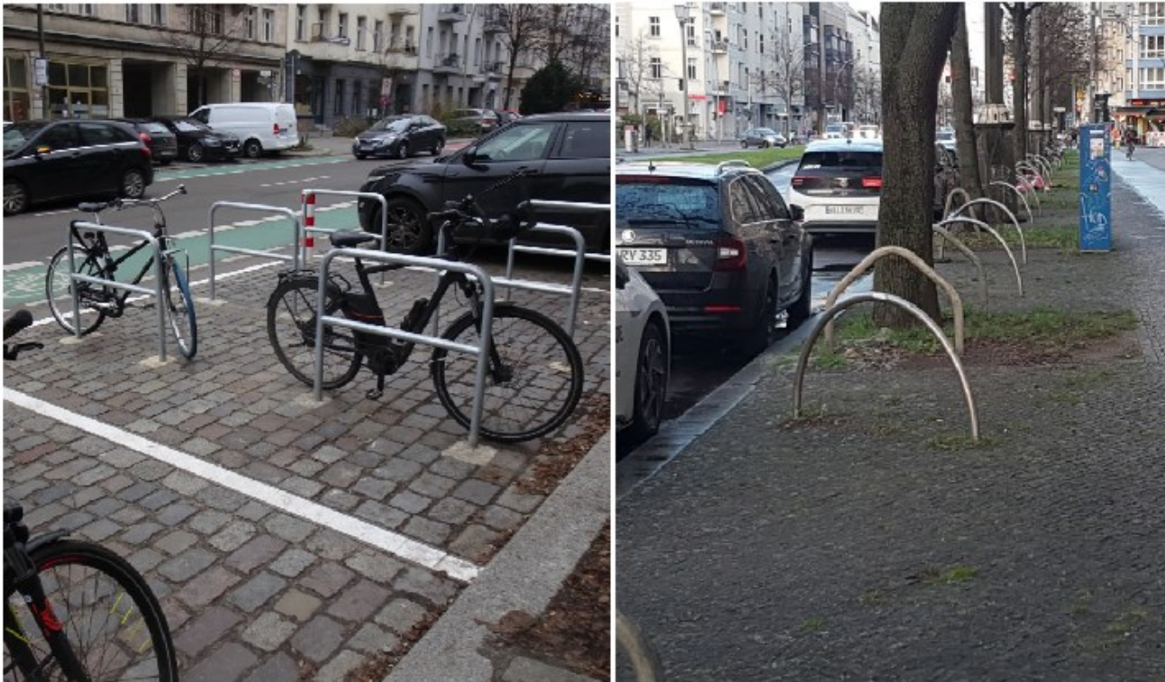
Abb. 4.7: Radbügel in rechteckiger und halbkreisförmiger Ausführung.
