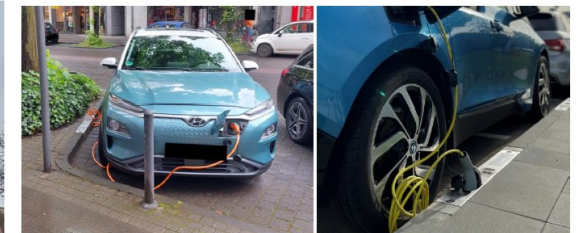
Abb. 5.10 Modell "Curb Charger" der Firma Pierburg, Das Lademodul findet in einem Beton-Hohlkörper von der Größe eines üblichen Hochbordsteins Platz. Ein externer Stromanschlusskasten ist erforderlich. (© Pierburg / Rheinmetall AG)
